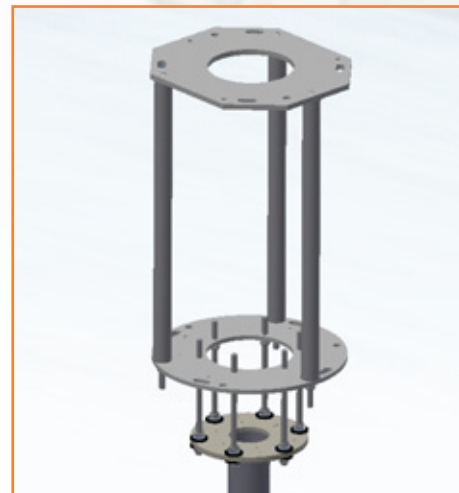
支撑架配合可调安装板提供最大限度的空间
